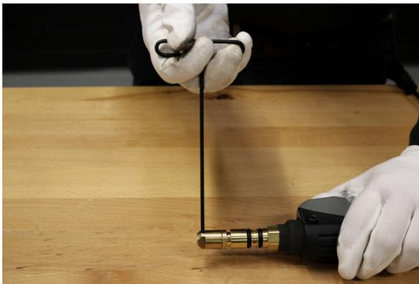
2. Remplacez la nouvelle gaine à travers le collet jusqu'à ce que le fond de la gaine en laiton s'enclenche dans le fond du collet.
