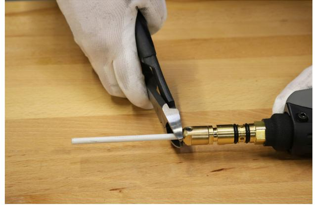
7. Insérez un morceau de fil de soudure dans la gaine pour vérifier si des bavures ou des obstructions sont présentes. Au besoin, desserrez légèrement la vis jusqu'à ce que le fil glisse librement.
