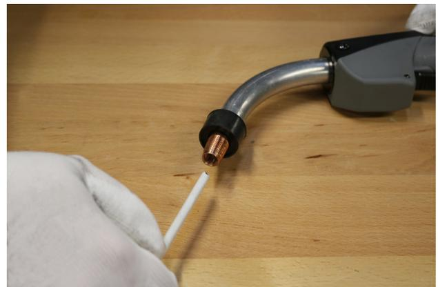
3. Verrouillez et centrez la gaine en réinstallant le diffuseur. Faites glisser le capuchon de la goupille d'alimentation sur la gaine exposée et serrez le capuchon contre l'épaulement de la goupille d'alimentation à l'aide d'une pince à souder ou d'une clé appropriée.
